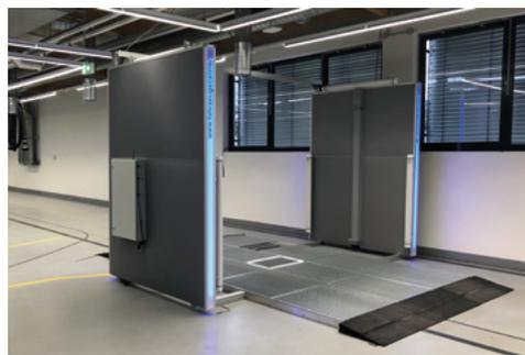
In dieser Anlage des Projekts DigiDet nehmen Kameras Bilder des Autos auf und ermitteln automatisch Schäden an der Außenhaut. Quelle: Fraunhofer IPA / Foto: Yifei Chen.
