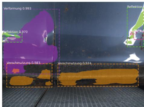
Die im Projekt entwickelten Algorithmen der Bildverarbeitung haben den lilafarbenen Bereich als Schaden an der Karosserie erkannt. Quelle: Fraunhofer IPA.
